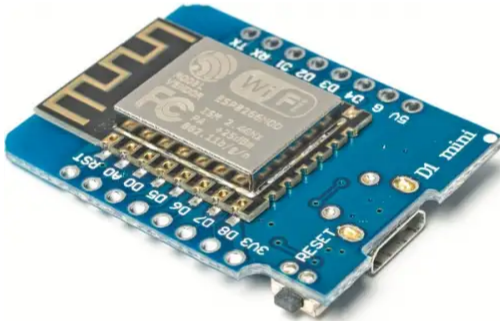
Der Wemos D1 mini (und seine Nachbauten) ist die günstigste ESP-Platine mit USB-Konverterchip.
