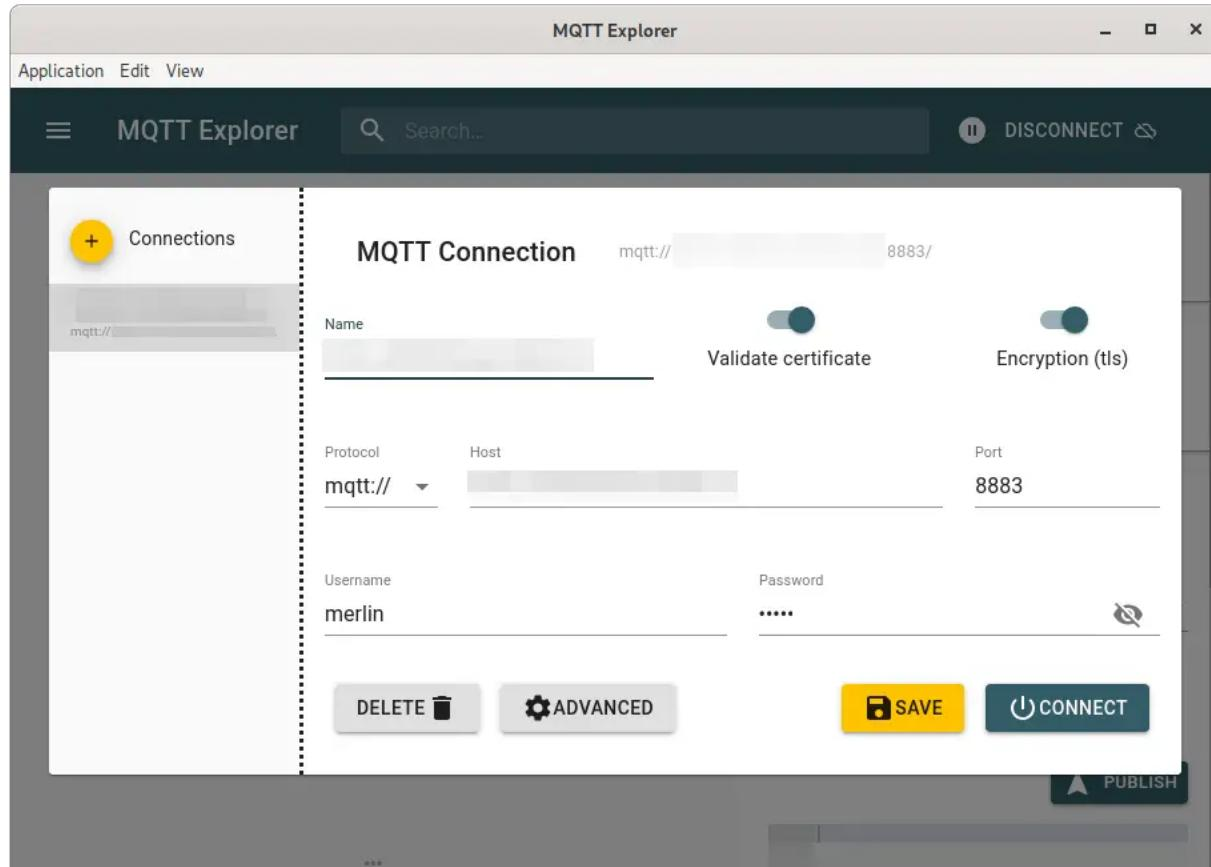
Der MQTT-Explorer ist ein hilfreiches Werkzeug beim Testen von MQTT-Verbindungen.
