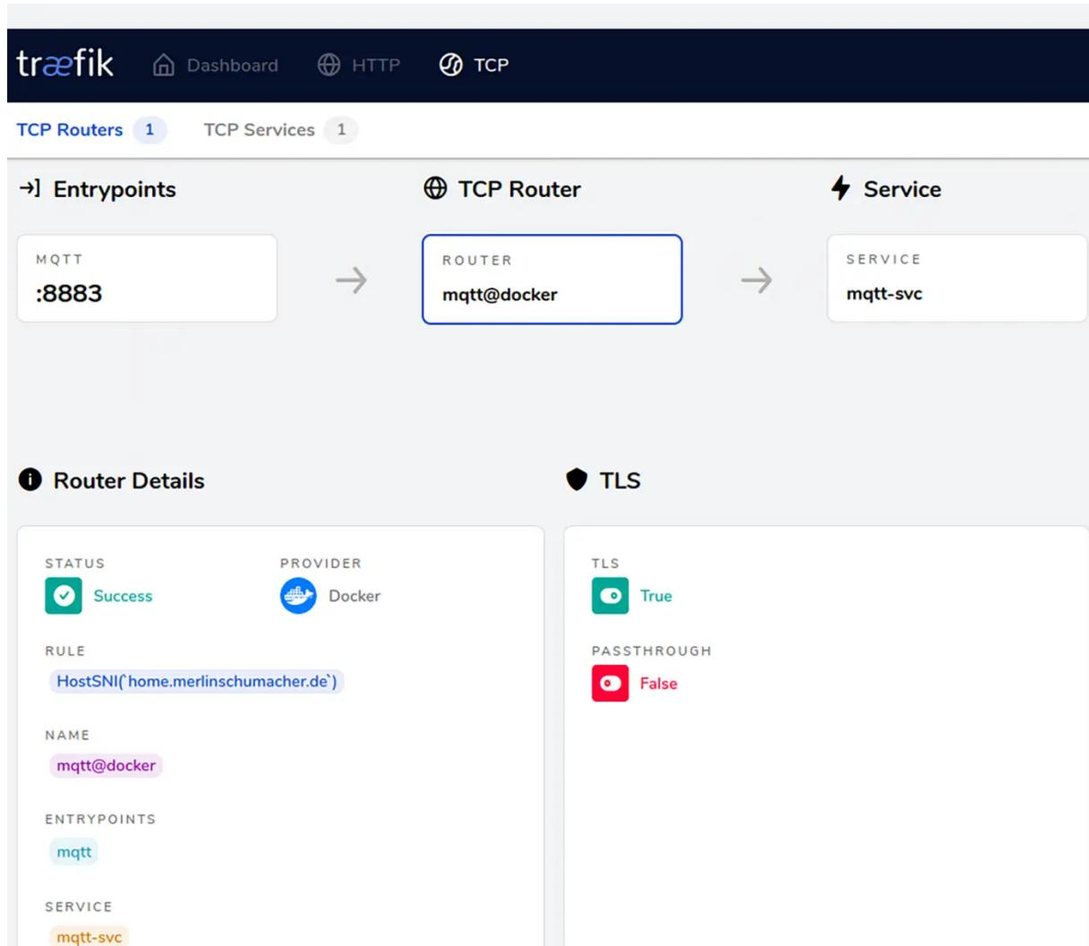
In Traefiks Dashboard kann man sehen, ob das Routing und die TLS-Terminierung funktionieren.
